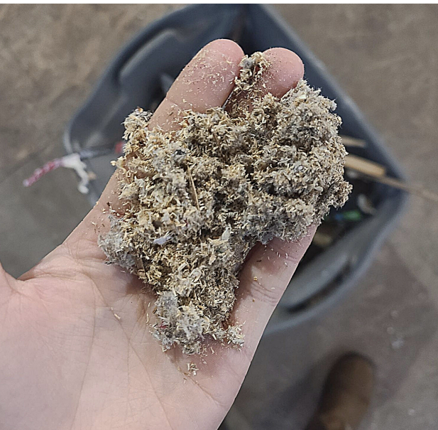
Emilie et Janelle au troisième étage; le système d'eau de pluie; cellulose (isolant)
